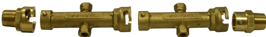
Para conectar una regleta RETROL® solo necesitaremos disponer de los cuerpos RETROL® (tantos como queramos conectar) y una única conexión terminal para situar roscas de  $\frac{3}{4}$ " macho en sus laterales.
