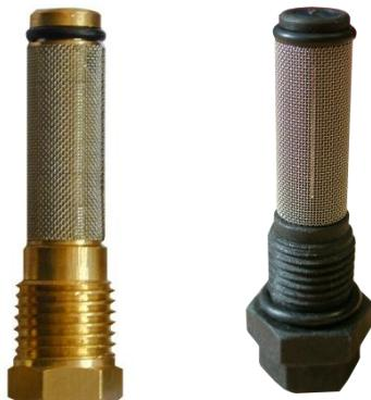
El Filtro de Toma se utiliza para proteger de obstrucciones el circuito exterior de la válvula hidráulica equipada. Generalmente se sitúa en la toma de presión aguas arriba de la válvula. Es importante utilizar el filtro de toma de tal manera que tenga superficie suficiente en contacto con el flujo de la tubería pero que no cree una pérdida de carga excesiva.
